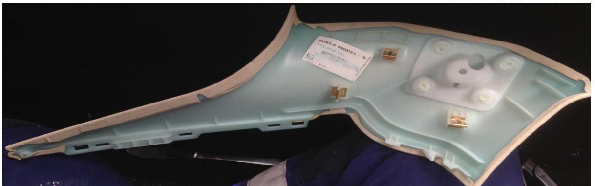
17. Bruk trekksnoren for å trekke frem signalkabelen under det dekselet på C-stolpen du akkurat har demontert. Dra med deg den ekstra lengden som henger ned over bjelken i taket. Dyt inn signalkabelen over taktrekket langs glasstaketet over baksetene.
