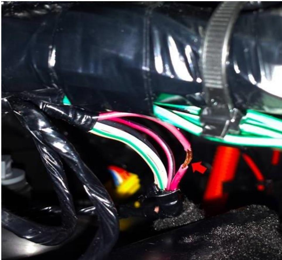
4. Koble til ledningen med sikringsholderen til denne ledningen. Tvinn godt, skjøt inn sammen i kabelsko eller lodd de sammen. Den tynne røde ledningen trenger ikke være lengre enn maks 1 meter. Isolér den løse enden med elektrikerteip. Avvent gjerne med å sette i sikringen til jobben er helt ferdig.
