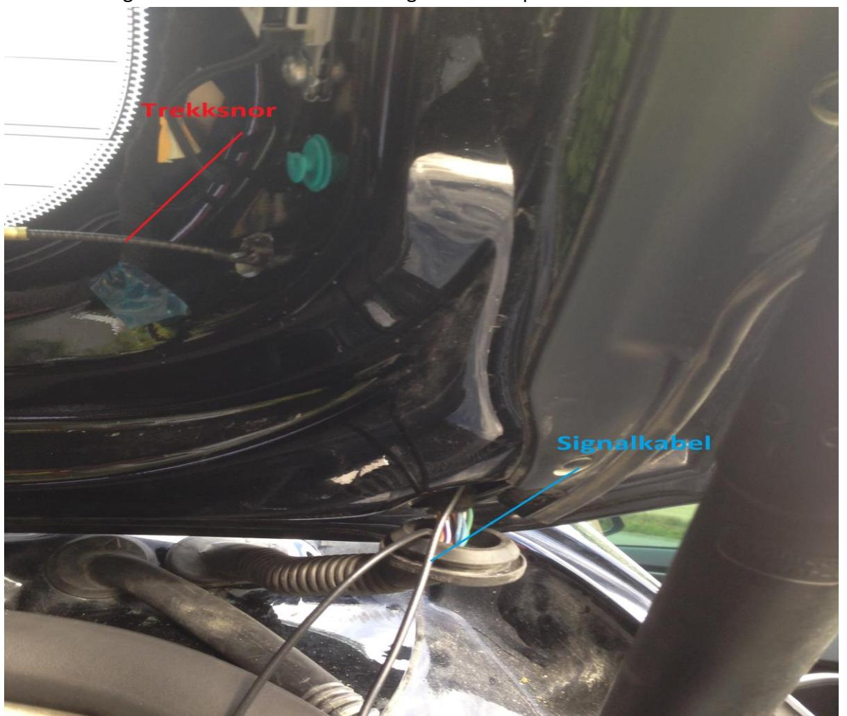
24. Fest det bakre kameraet helt oppe på bakruten med tilkoblingen mot venstre på bilen. Fest signalkabelen med små strips i kabelen til bremselysene som ligger i samme område. Resterende signalkabel stripes fast og skjules bak plastdekselene rundt bagasjeluken.
