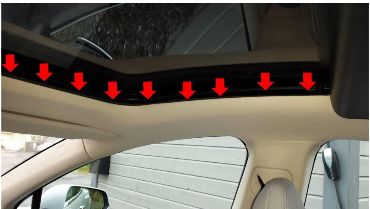
15. Videre skal signalkabelen trekkes bak mot bagasjeluken.
