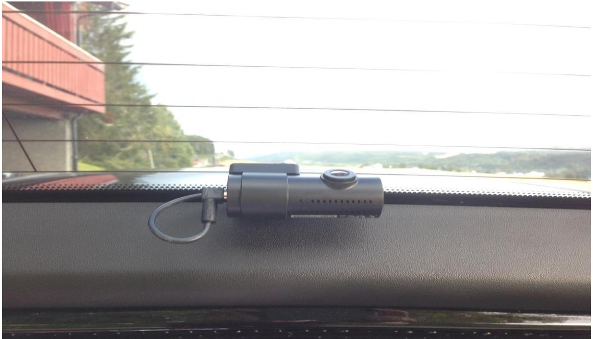
25. Strømkabelen til frontkameraet henges opp sammen med signalkabelen over speilet før kabelen enkelt puttes inn bak taktrekket langs frontruten, bruk smørkniven for å lirke ned taktrekket nok til å få inn strømkabelen.
