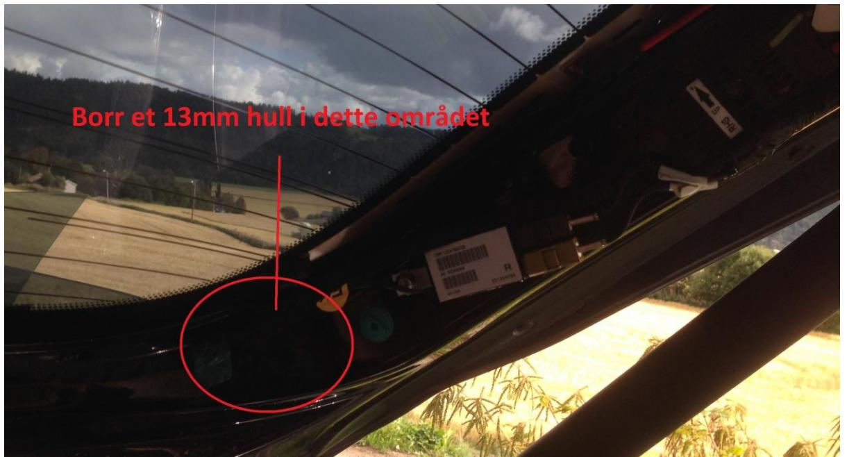
23. Tre inn trekksnoren inn i hullet du har borret og ut i hullet hvor gummistrømpen i bakluka er tatt løs. Teip fast signalkabelen og trekk den ut igjennom hullet i bakluka. Trekk ut all signalkabelen før du remonterer gummistrømpen i bakluka.
