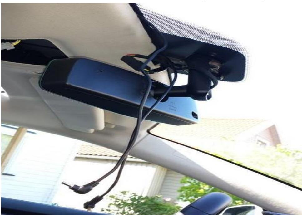
13. Tre inn trekksnoren over den sorte «bjelken» i taket bak panoramataket slik som bildet under. Teip så den andre enden på signalkabelen til trekksnoren og trekk igjennom kabelen slik at den henger ned bak denne «bjelken». Det kan hjelpe å åpne panoramataket for å se hvor trekkesnoren skal komme over «bjelken».
