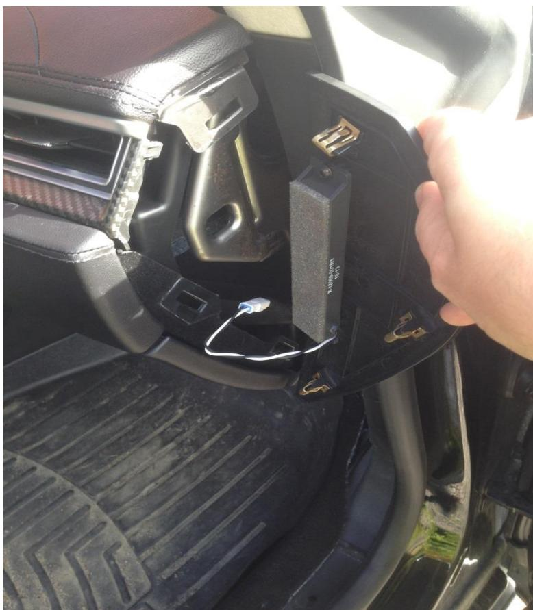
7. Plastdekselet som ligger langs døra og opp foran vipper du enkelt ut med smørkniven. Vær forsikring med de blå klipsene, da de ikke tåler all verden (knekker de har Tesla slike liggende).
