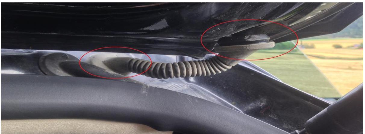
19. Dytt inn trekksnoren i hullet i bilen og finn igjen den ved C-stolpen, teip fast signalkabelen og dra den ut slik at den henger ut av hullet i bilen.
