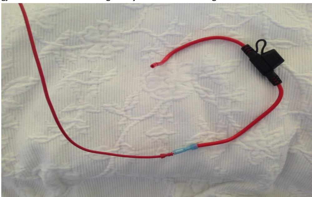
5. Teip sammen for å isolere mot kortslutning for så å stripse fast ledningen med sikringsholderen til den store kabelpølsen inne i hanskerommet.
