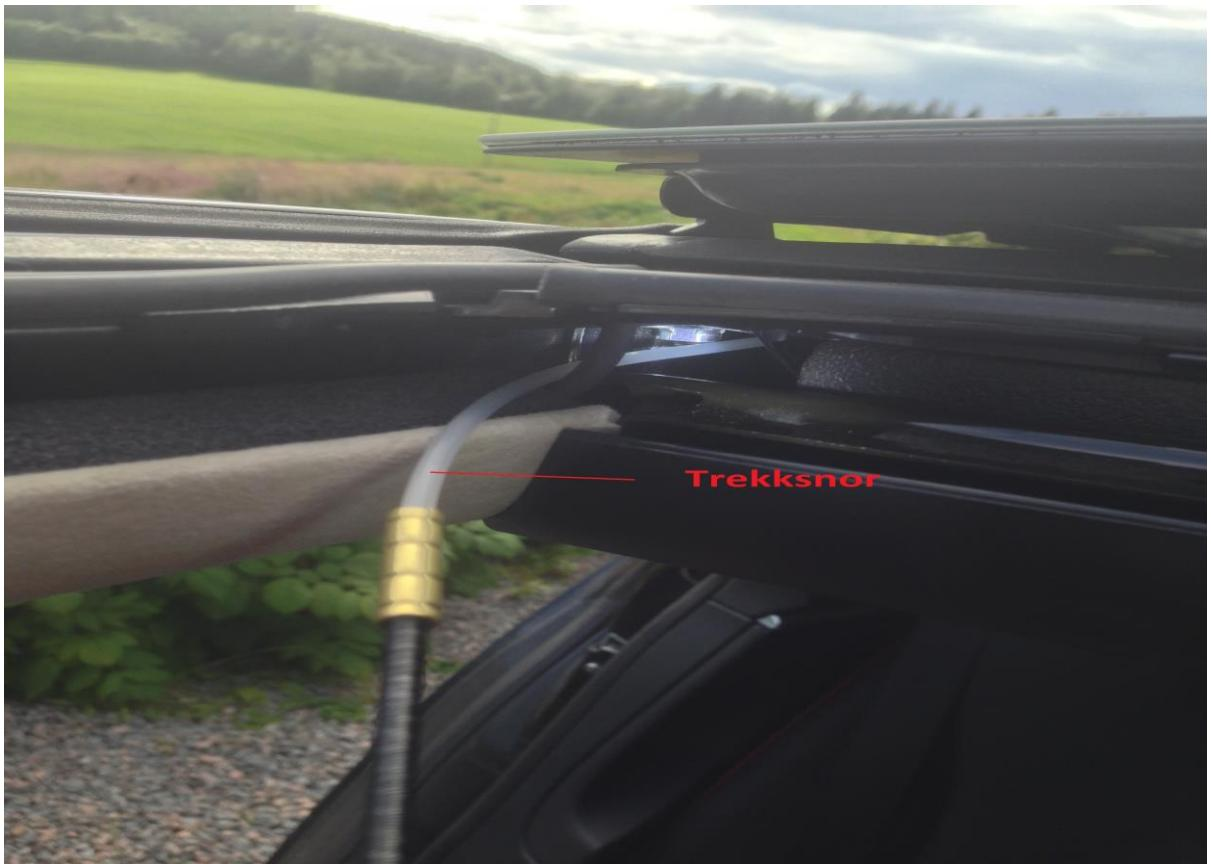
14. Dytt inn signalkabelen under taktrekket og stram den opp ved å dra i enden som henger ned bak «bjelken» i taket.
